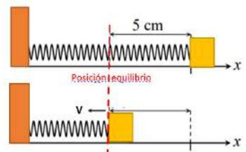
Para calcular la velocidad aplicamos la conservación de la energía:  $E_{\text{total}} = E_p + E_c \Rightarrow \frac{1}{2} kA^2 = \frac{1}{2} kx^2 + \frac{1}{2} mv^2 \Rightarrow$
