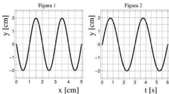
a) De la figura 1 obtenemos que la longitud de onda es  $\lambda = 2 \text{ cm} = 0,02 \text{ m}$
