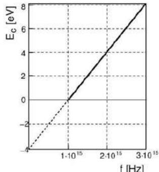
a) La frecuencia umbral que tiene el fotón de mínima energía para liberar un electrón de un metal es, viendo la gráfica:  $f_0 = 1 \cdot 10^{15} \text{ Hz}$ . Por tanto su longitud de onda será:  $\lambda_0 = c/f_0 = 3 \cdot 10^8 / 1 \cdot 10^{15} = 3 \cdot 10^{-7} \text{ m} = \lambda_0$
