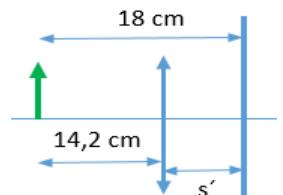
b) Este apartado tiene cierta dificultad para realizar el trazado por estar muy junto en la zona de los dos espejos y la pantalla anterior, siendo ahí donde vamos a observar que la 1<sup>a</sup> imagen, que será el objeto de la 2<sup>a</sup> lente está justo sobre el foco de esta nueva lente:
