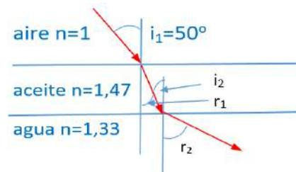
ii) Velocidad de la luz en el agua:  $n_{\text{agua}} = \frac{c}{v_{\text{agua}}} = 1,33 = \frac{3 \cdot 10^8}{v_{\text{agua}}} \Rightarrow v_{\text{agua}} = 2,26 \cdot 10^8 \text{ m/s}$
