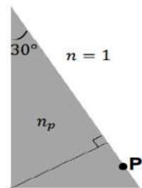
a) El ángulo límite  $\theta_L$  para la reflexión total interna se define cuando el rayo pasa de un medio más denso  $n_p$  a un medio menos denso  $n=1$ . El rayo refractado en el aire forma un ángulo de  $90^\circ$  con la normal.
