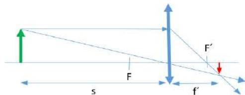
17) a) Realice y explique el trazado de rayos para un objeto situado entre el foco objeto y una lente convergente. Justifique las características de la imagen. b) Un objeto de 30 cm de altura se coloca a 2 m de distancia de una lente delgada divergente. La distancia focal de la lente es de 50 cm. Indicando el criterio de signos aplicado, calcule la posición y el tamaño de la imagen formada. Realice razonadamente el trazado de rayos y justifique la naturaleza de la imagen.
